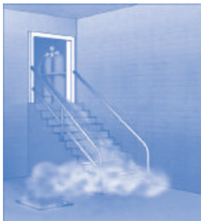
Слика 2.3: Ширење кондензованих гасова (пример) 4
