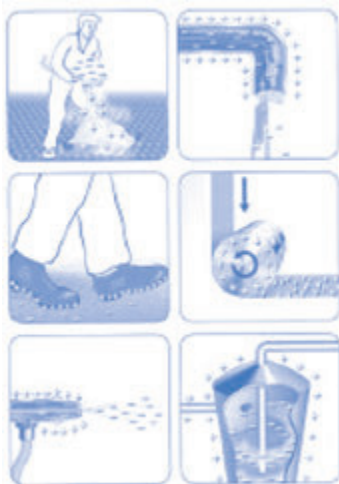
Слика 3.6: Примери раздвајања наелектрисања која могу да доведу до електростатичког наелектрисања 4 (набоја)
