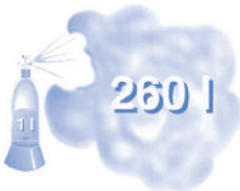
Слика 2.4: Испарење сасвим малих количина запаљиве течности (као што је кондензован пропан) може довести до стварања великих количина запаљивих пара.
