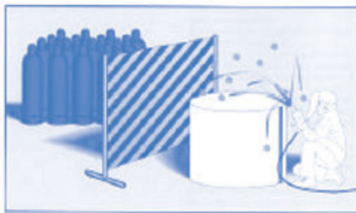
Слика 4.2: Пример заштите преградом приликом рада током којег може доћи до варничења 4
