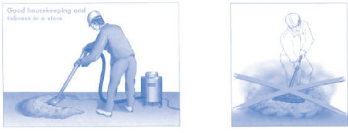
Слика 3.2: Уклањање наслага прашине 4
